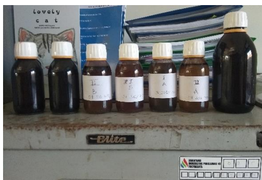
Gambar 5. Liquid Smoke atau Asap Cair Hasil Pirolisis Limbah Ampas Teh
