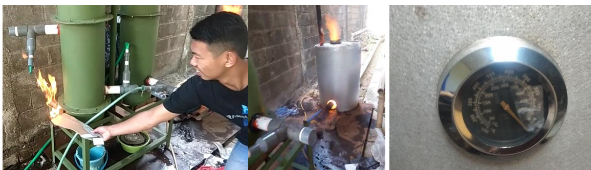
Gambar 3. Pembakaran Gas Pirolisis (kiri) , Proses Pirolisis (tengah), suhu puncak (kanan)
